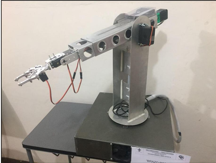
Figura 5. Prototipo del robot de configuración esférica.
